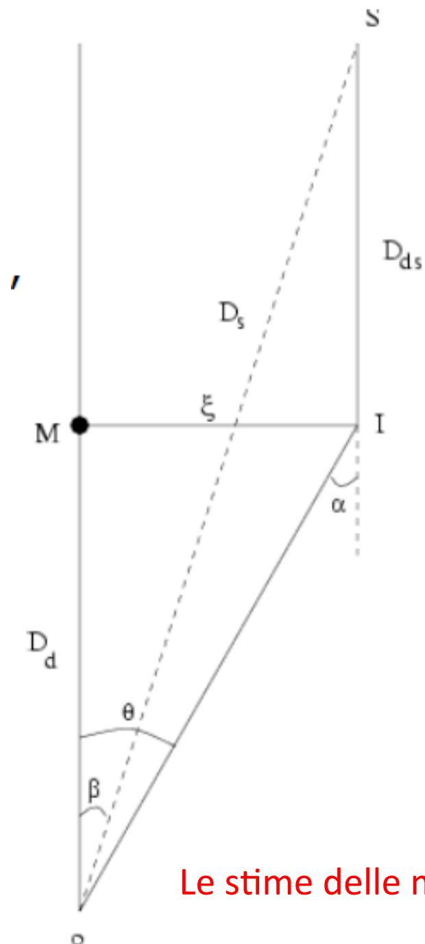
$$\beta = \vartheta - \frac{D_{ds}}{D_s} \alpha = \vartheta - \frac{D_{ds}}{D_s} \frac{4GM}{c^2 \xi}$$
